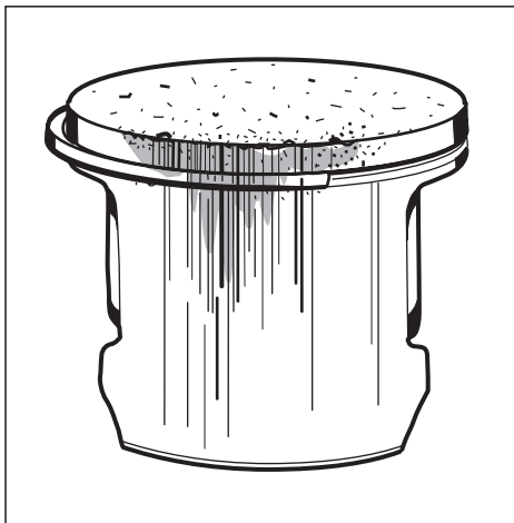
Сторона выхлопа повреждена треснувшим поршневым кольцом. Части поршневого кольца повредили верхнюю часть поршня и оставили царапины.
