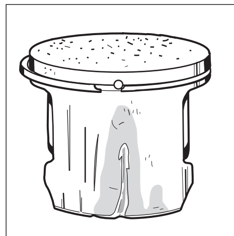
Нерегулярные бороздки на поршне на стороне всасывания, обусловленные поломкой сепаратора роликоподшипника.
